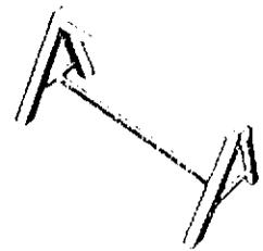
Fig. 89. — Mise en place des tréteaux d'extrémités.
